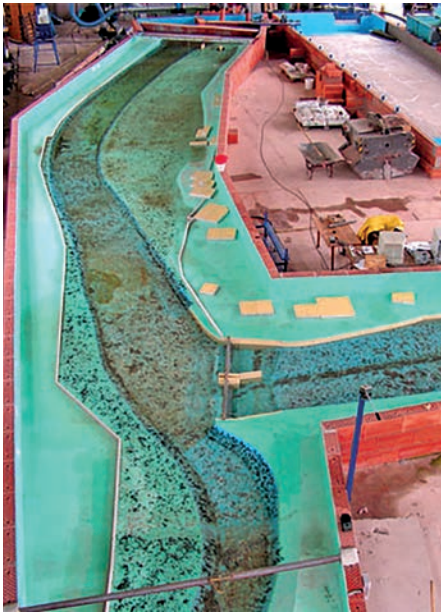
Modellversuch Verteilerwehr (2006) (Foto: LTV)
