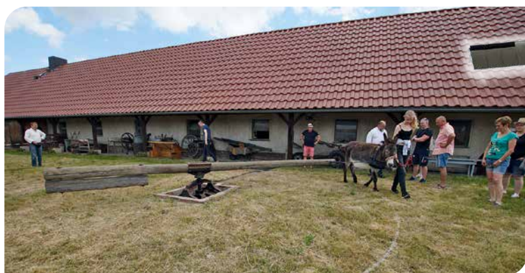
Die Esel Klaus (15 Jahre) und Marie (13 Jahre) zeigen den Gästen zum Mühlentag wie eine Göpelmühle funktioniert, der Mühlstein ist im Gebäude. (Fotos: Frank Thomas)
