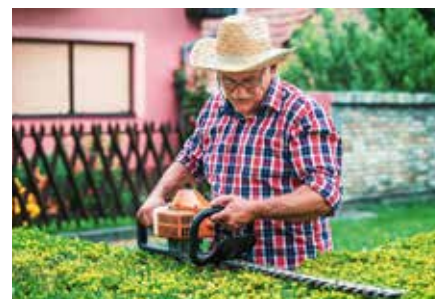
Beim Halten am vorderen Handgriff muss die Schwerpunktage eine waagerechte Balance der Schere ermöglichen.
