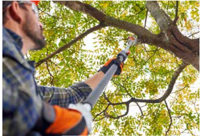
Ein Hochtaster erlaubt Schnitte oben im Baum mit festem Stand auf dem Boden. (Foto: DJD/STIHL)
