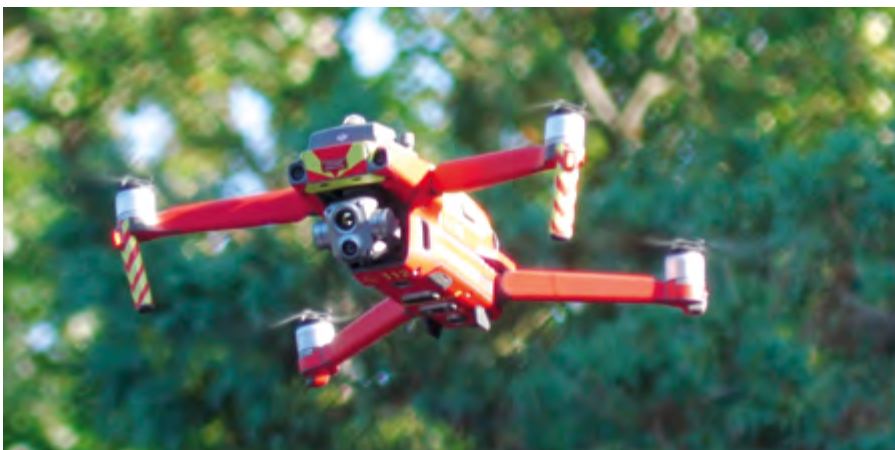
Die Drohne der Drohnstaffel des Landkreis Leipzig kann sowohl ein hochauflösendes Live-Bild als auch spezielle Wärmebilder liefern.
