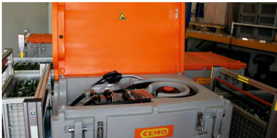
Einige Feuerwehren im Landkreis Leipzig wurden mit Notbetankungssystemen ausgestattet. Sie bestehen aus mobilen Tankstellen und Benzinreservebehältern.
