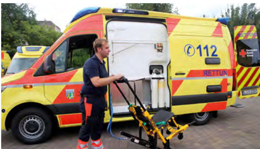
Durch das neue Heckdesign wird die Sicherheit im Straßenverkehr erhöht. Zudem erleichtert der Raupenstuhl den Personen-Transport über Treppen.
